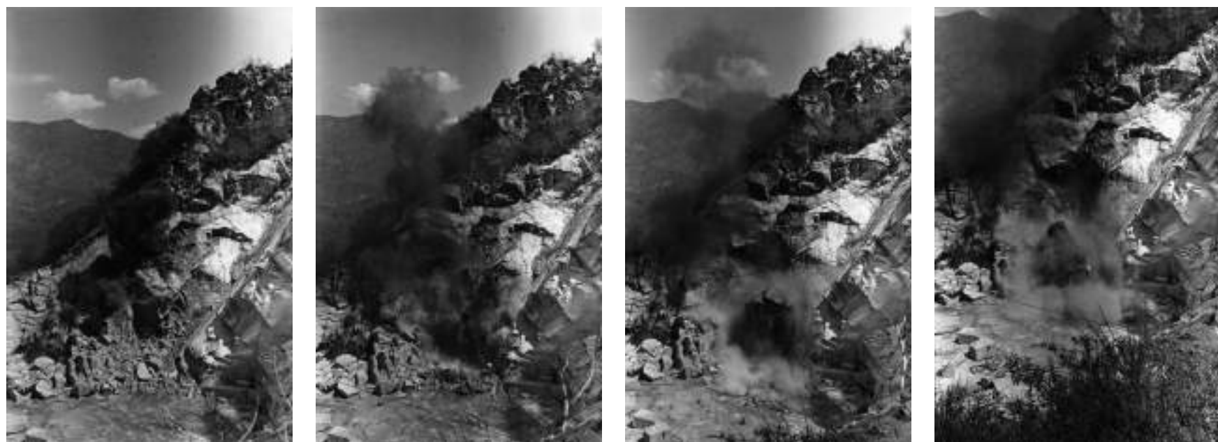
Esplosione di una mina: la caduta del masso sul piazzale della cava.
